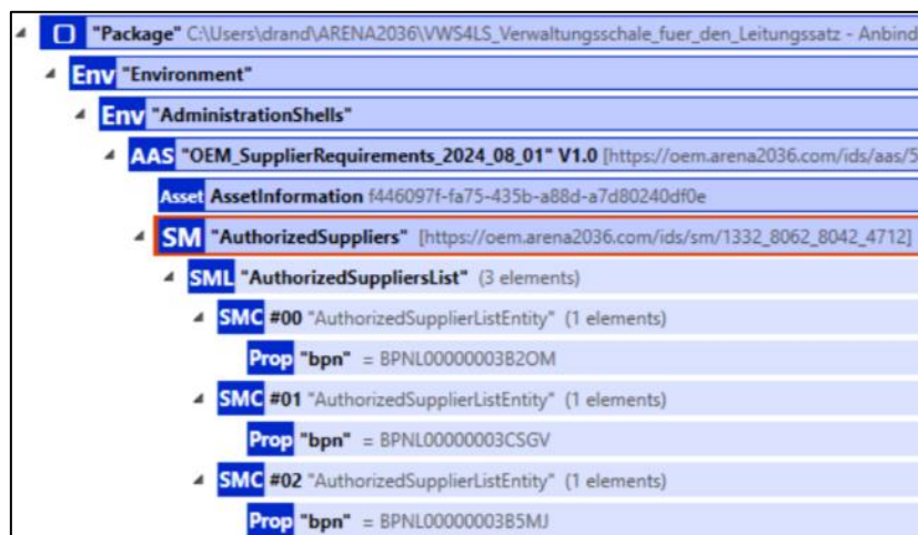
Abbildung 9-17: Die Anforderungen des OEM als AAS mit Submodel
