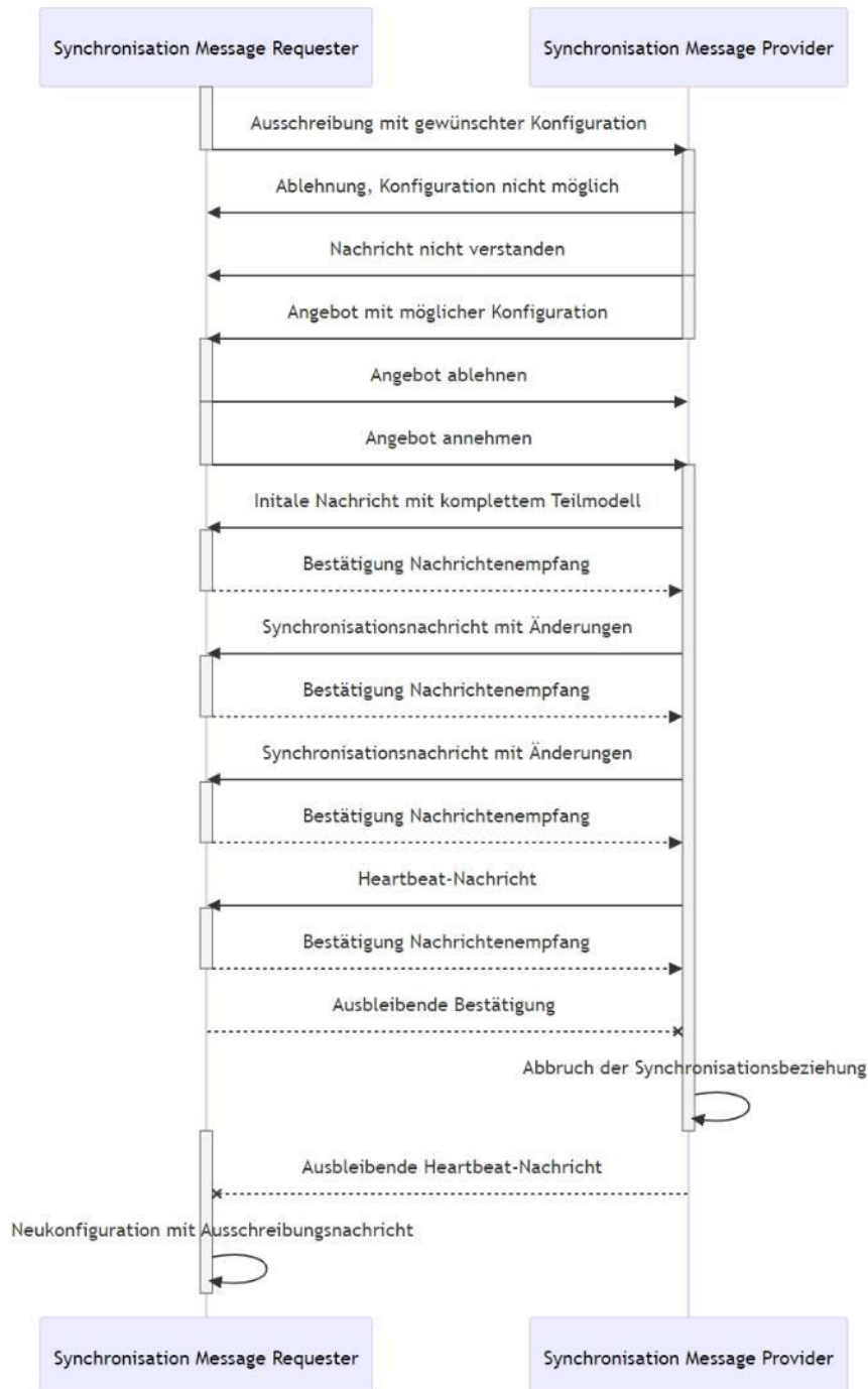
Abbildung : Interaktionsprotokoll zur VWS-Synchronisation
