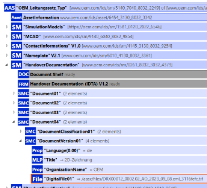
Abbildung 3-23: OEM-Verwaltungsschale für den Gesamtleitungssatz
