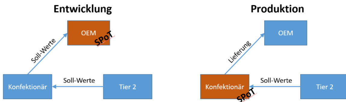
Abbildung 12-4: Wechselnder SPoT im Lebenszyklus des Leitungssatzes
