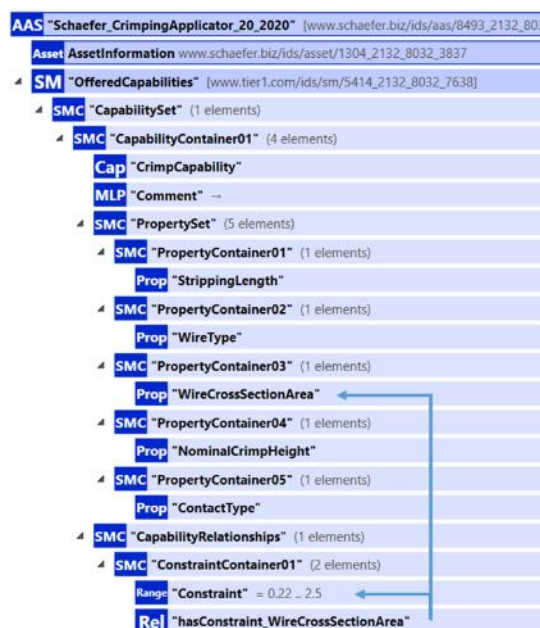
Abbildung 6-25: Exemplarisches Teilmodell "OfferedCapabilities"
